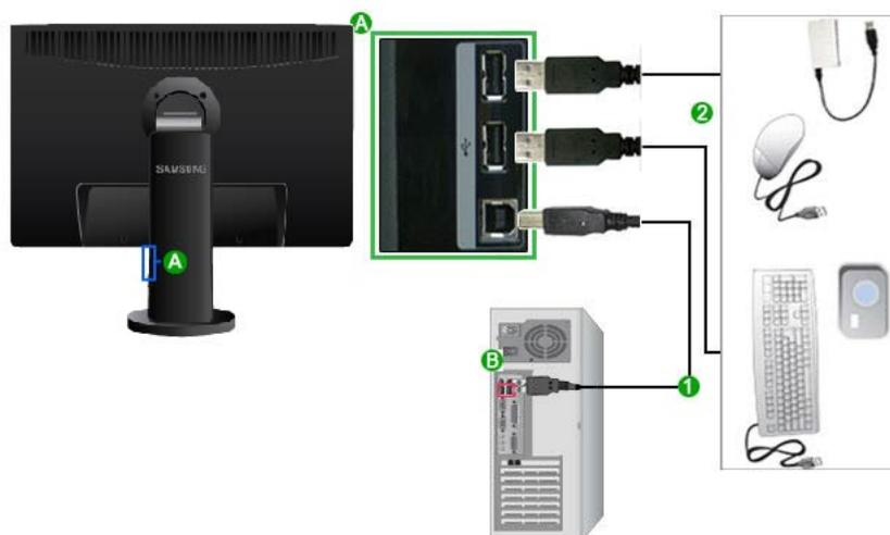
1. Conecte el puerto UP del monitor al puerto USB del ordenador mediante el cable USB.
