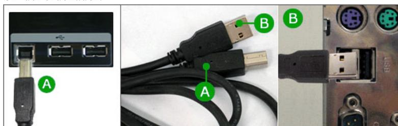
2. Conecte el puerto DOWN del monitor USB y un dispositivo USB mediante el cable USB.
