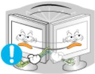
**• No mueva el monitor a la izquierda o a la derecha jalando solamente el cordón o el cable de señal.**
