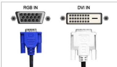
Terminal de conexión de la computadora (15 contactos D-SUB)
