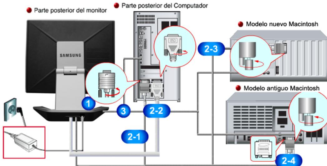
1. Conecte el cordón de suministro eléctrico del monitor a la toma de corriente de la parte trasera del monitor. Enchufar el cordón de suministro eléctrico del monitor a un tomacorriente cercano.
