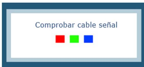
La ausencia de una de las cajas indica un problema en el monitor. Esta caja también aparece durante la operación normal si el cable de video se desconecta o se daña.
