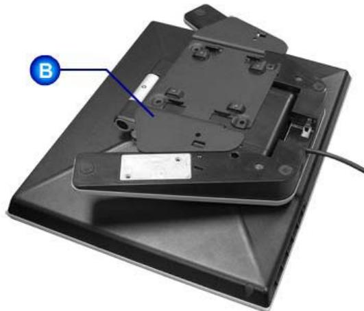
Pliegue la base y deje el área conectada con el cable boca abajo antes de situar en ella el soporte para el montaje del aparato. Alinee los orificios de la superficie para el montaje del aparato con los orificios de la base **B** y fíjelos firmemente con cuatro tornillos.
