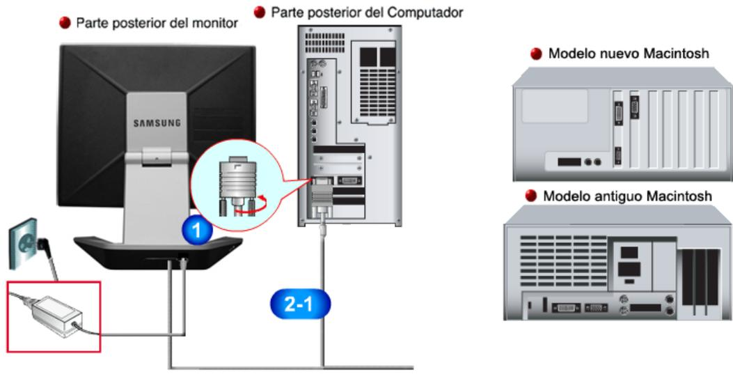
1. Conecte el cordón de suministro eléctrico del monitor a la toma de corriente de la parte trasera del monitor. Enchufar el cordón de suministro eléctrico del monitor a un tomacorriente cercano.
