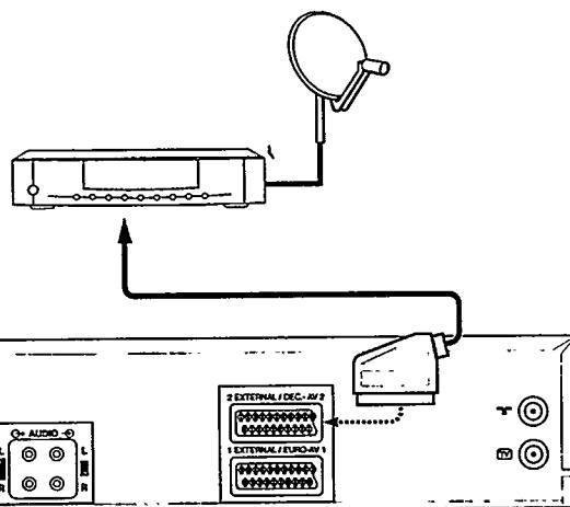
① Συνδέστε το δέκτη στο βίντεο (υποδοχή **DEC - AV 2**) χρησιμοποιώντας καλώδιο scart.
