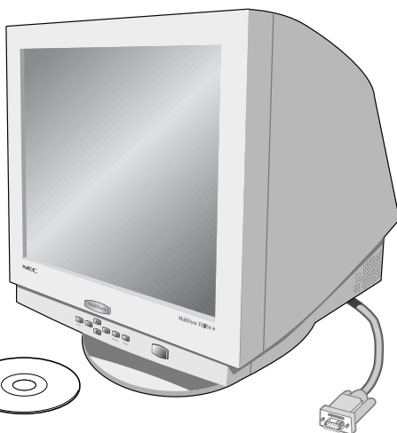
Cable de señal fijo
