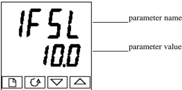
Figure 2-6 Typical parameter display
