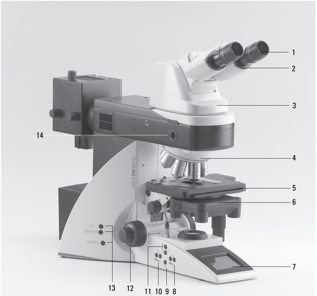
**Abb. 1** Linke Stativseite mit Advanced Ergotubus AET22
