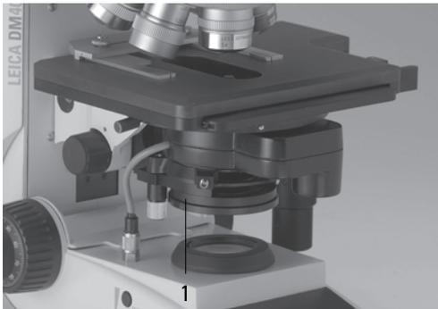
**Abb. 73** Analysator einschieben
