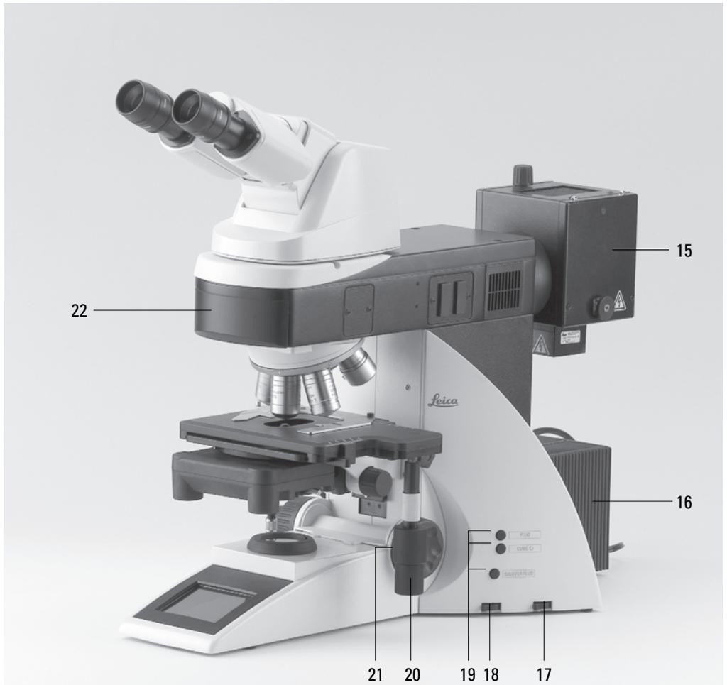
**Abb. 2** Rechte Stativseite mit Advanced Ergotubus AET22
