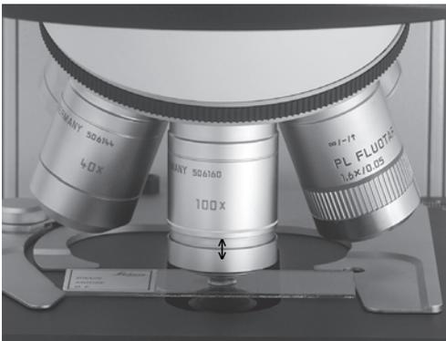
Abb. 63b Immersionsobjektiv, verriegelt
