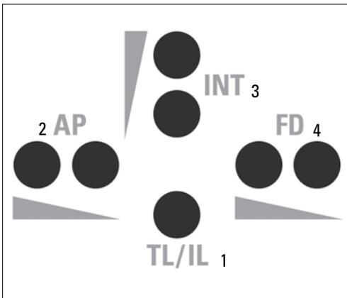
Die Tasten **AP** (38.4) für die Aperturblende und **FD** (38.2) für die Feldblende werden zum Öffnen bzw. Schließen der jeweiligen Blende verwendet.
