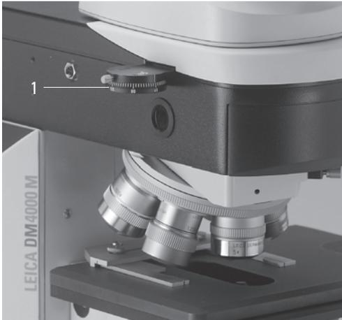
**Abb. 31** Einstecken des Objektiv-Prismenschiebers
