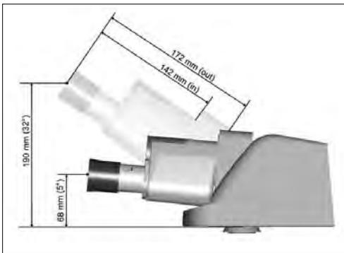
**Abb. 62** Tubus BDT25+ mit Digitalkamera
