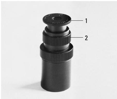
**Abb. 44a** Zentriervorgang Phasenkontrast
