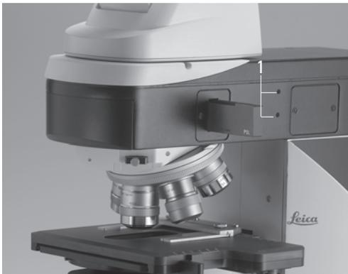
**Abb. 42b** Justierung der Aperturblende in der Auflichtachse
