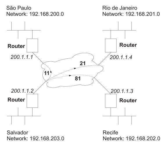
FIGURE 8.1 PERMANENT VIRTUAL CIRCUITS BETWEEN OFFICES
