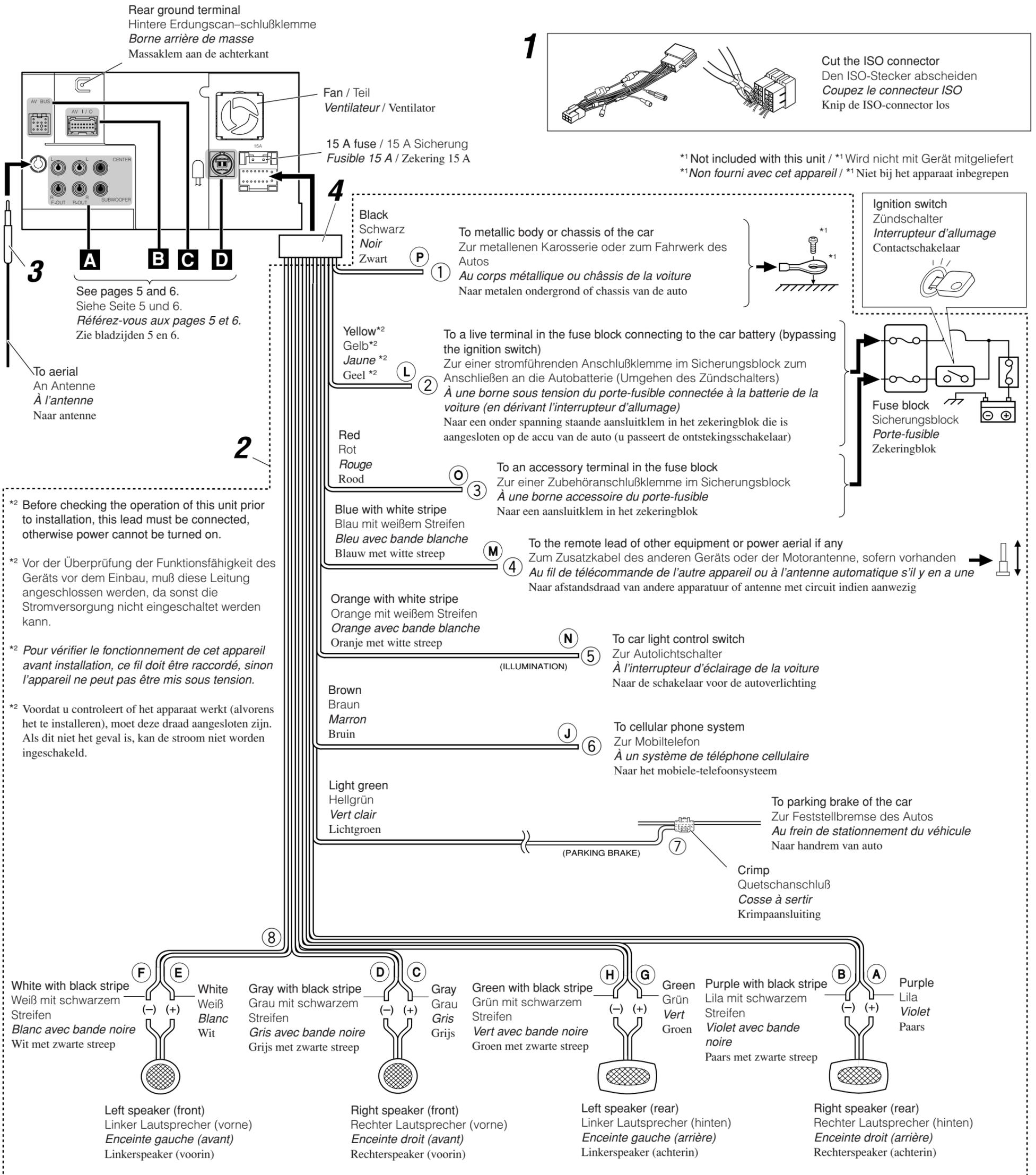
**A Connecting the external amplifiers / Anschließen der externen Verstärker / Connexion d'amplificateurs externes / Aansluiten van externe versterkers**
