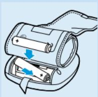
2 Åpne batterirommet, og sett inn to batterier av typen AAA (LR03).
