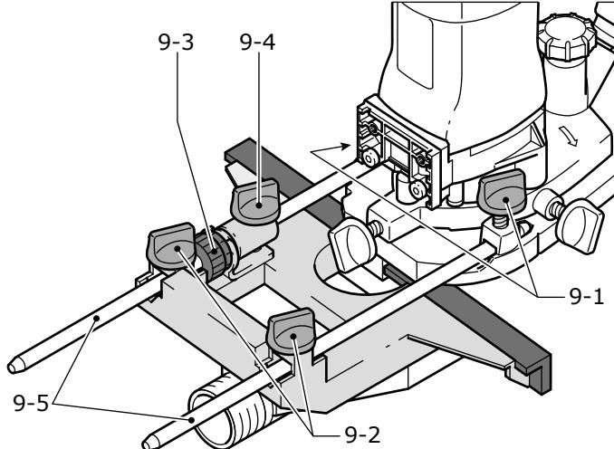
La butée latérale est utilisée pour des travaux de fraisage parallèlement au bord de la pièce. La butée latérale peut uniquement être montée sur la "table de fraisage grande surface" et sans capot d'aspiration monté.
