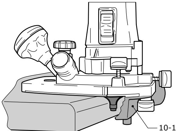
Para el tratamiento de cantos con la "mesa de fresar con gran superficie de apoyo" se colocan fresadoras con cojinete de arrastre en la máquina. De esta manera, la máquina se guiará de modo que el cojinete de arrastre gire en la pieza de trabajo.
