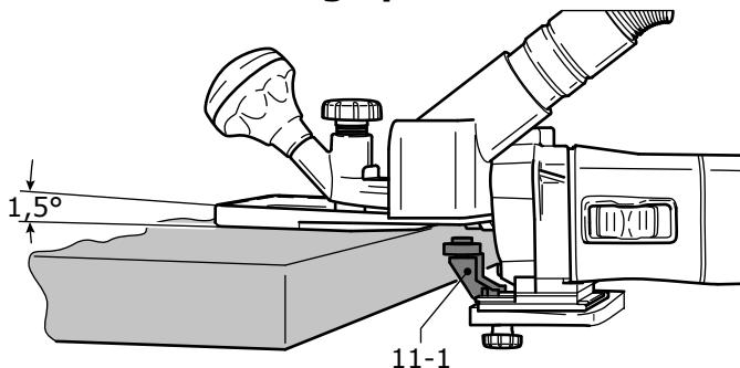
Le galet palpeur [11-1] est monté sur la machine pour le fraisage de chants avec la table de fraisage pour couvre-chants (uniquement dans le volume de livraison SET) (voir "Table de fraisage pour couvre-chants"). A cette occasion, la machine est guidée de façon à ce que le galet palpeur repose contre la pièce.
