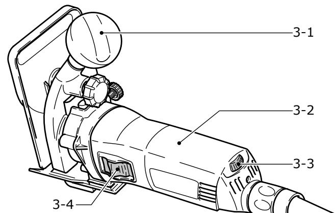
**ADVERTENCIA** La máquina tiene que ser sujetada siempre con ambas manos por las empuñaduras [3-1] [3-2] durante la conexión y el uso.
