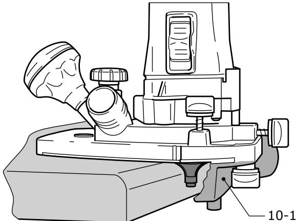
Des fraises avec roulement de guidage sont montées sur la machine pour le fraisage de chants. Dans ce cas, la machine est guidée de sorte à faire rouler le roulement à billes sur la pièce.
