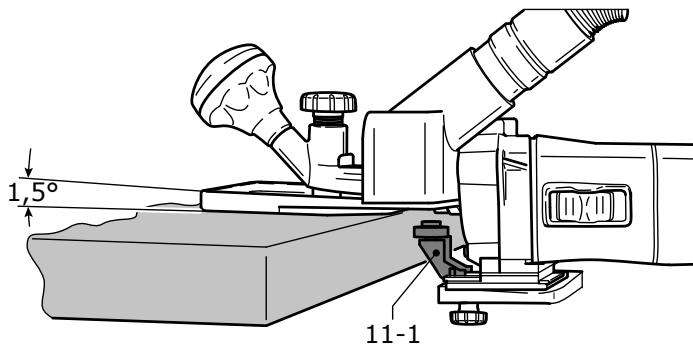
Para el tratamiento de cantos con la mesa de fresar para cantos preencolados (sólo en la dotación de suministro SET) se monta el dispositivo palpador [11-1] en la máquina (véase "Mesa de fresar para cantos preencolados"). De esta manera, la máquina se guiará de modo que el dispositivo palpador entre en contacto con la pieza de trabajo.
