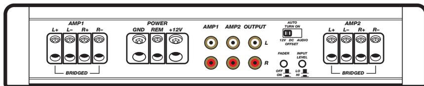
**Sélection de Mise sous Tension Automatique :** La série IX est dotée de trois modes différents de mise sous tension automatique pouvant être sélectionnés au panneau d'extrémité de l'amplificateur : +12V, DC Offset (décalage c.c.) et Audio. L'utilisation du mode DC Offset ou Audio permet à la borne REM d'avoir une sortie de +12 V pour des amplificateurs supplémentaires.
