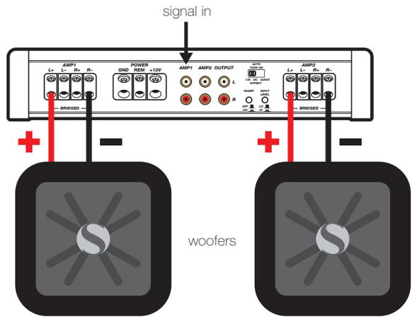
**STEREO-AND-MONO-SIMULTANEOUSLY (SAMS) OPERATION**
