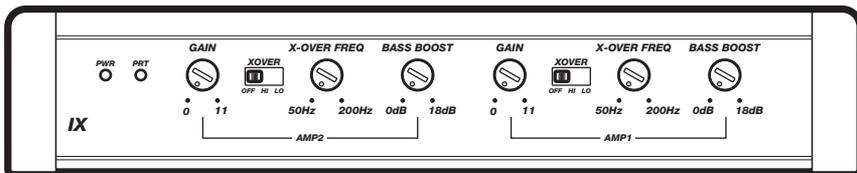
**Eingangsverstärkungsregler:** Der Eingangsverstärkungsregler ist kein Lautstärkeregel. Er passt den Ausgang des Autoradios an den Eingangspegel am Verstärker an. Stellen Sie das Autoradio auf etwa 3/4 der Lautstärke ein (wenn es also bis 30 geht, wählen Sie 25). Drehen Sie dann langsam den Verstärkungsregler am Verstärker (im Uhrzeigersinn), bis Sie eine hörbare Verzerrung feststellen. Drehen Sie ihn dann wieder etwas zurück.
