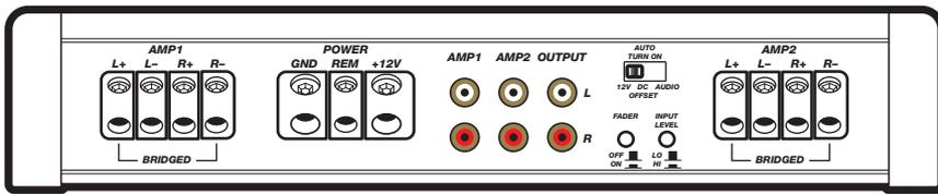
**Automatische Einschaltung:** Die IX-Serie bietet drei verschiedene automatische Einschaltmethoden, die an der Endplatte gewählt werden können: +12V, DC Offset und Audio. Wenn Sie „DC Offset“ oder „Audio“ verwenden, wird am REM-Terminal +12V für das Einschalten weiterer Verstärker bereit gestellt.
