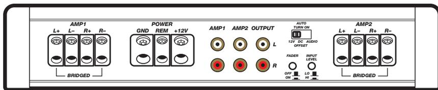
**Selección de Encendido Automático:** La serie IX ofrece tres modalidades de encendido automático que se pueden seleccionar en el panel de extremo: +12V, compensación de CC y audio. Las modalidades de audio o compensación de CC dan +12V a la terminal REM para encender otros amplificadores.
