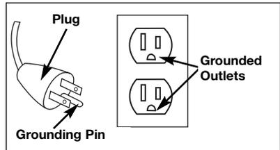
**⚠ WARNING** **IMPROPER GROUNDING CAN RESULT IN ELECTRICAL SHOCK.**
