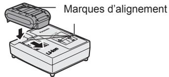
3. Le témoin s'allume pendant la charge. Lorsque la charge est terminée, un interrupteur électronique s'actionne pour protéger la batterie.
