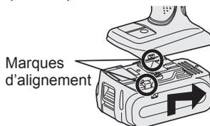
2. Pour retirer la batterie autonome:
