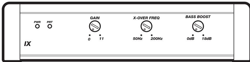
**Eingangsverstärkungsregler:** Der Eingangsverstärkungsregler ist kein Lautstärkeregler. Er passt den Ausgang des Autoradios an den Eingangspegel am Verstärker an. Stellen Sie das Autoradio auf etwa 3/4 der Lautstärke ein (wenn es also bis 30 geht, wählen Sie 25). Drehen Sie dann langsam den Verstärkungsregler am Verstärker (im Uhrzeigersinn), bis Sie eine hörbare Verzerrung feststellen. Drehen Sie ihn dann wieder etwas zurück.
