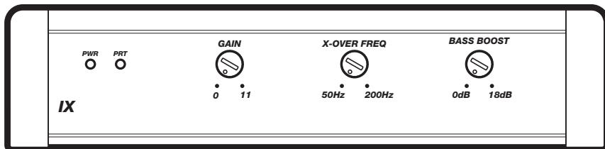
**Commande du Gain d'Entrée :** La commande du gain d'entrée n'est pas une commande de volume. Elle fait correspondre la sortie de l'appareil source au niveau d'entrée de l'amplificateur. Réglez l'appareil source à environ ¾ du volume (si le réglage de l'appareil source va jusqu'à 30, réglez à 25). Ensuite, augmentez lentement le gain de l'amplificateur en faisant tourner le bouton (dans le sens des aiguilles d'une montre) jusqu'à produire une distorsion audible, puis baissez un peu le gain.
