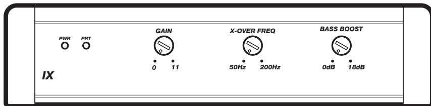
**Control de Amplificación de Entrada:** El control de amplificación de entrada no es un control de volumen. El control de amplificación de entrada hace que la salida de la fuente corresponda al nivel de entrada del amplificador. Suba el volumen de la unidad fuente a 3/4 (si la unidad llega a 30, súbale el volumen a 25). A continuación, suba lentamente la amplificación (girando el control en el sentido de las manecillas del reloj) hasta que pueda oír distorsión, luego bájela un poquito.
