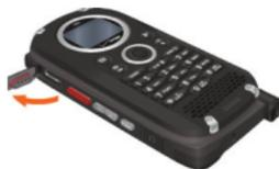
2. Inserte el enchufe de energía eléctrica del cargador de pared en una tomacorriente, y conecte el conector del cargador de pared al puerto de Carga/Datos.
