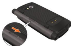
2. Inserte la punta del dedo en el hueco ①, y luego tire la tapa de batería hacia arriba en la dirección indicada por la flecha de la figura derecha ②.
