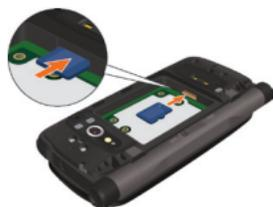
5. Instale la batería y coloque la tapa de batería. Asegúrese de que la Cerradura de Tapa de Batería se haya deslizado hasta la posición LOCK.
