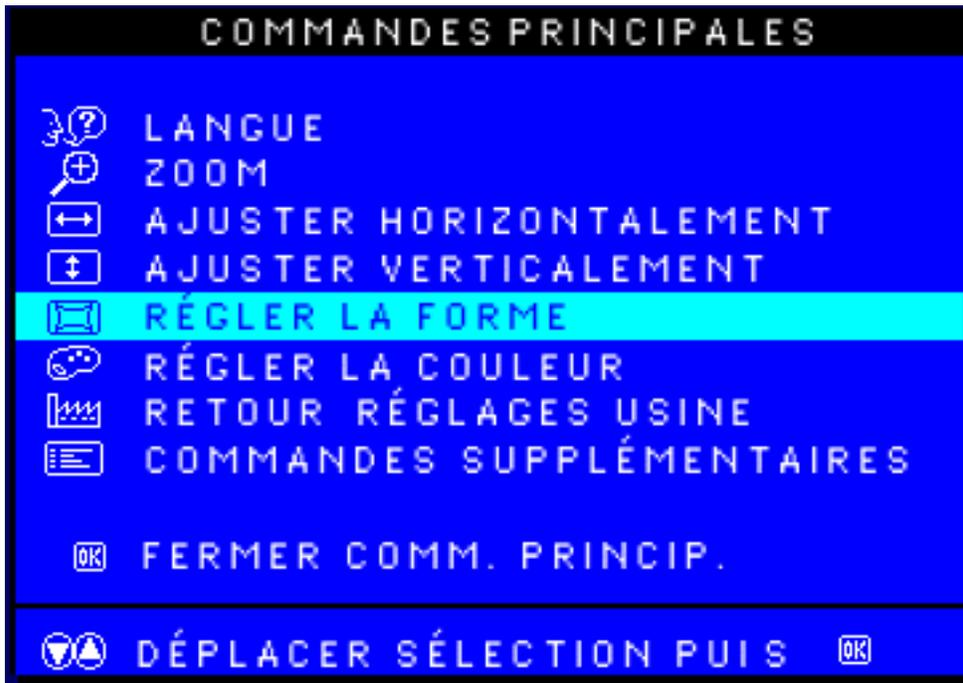
3) Appuyez sur le bouton
