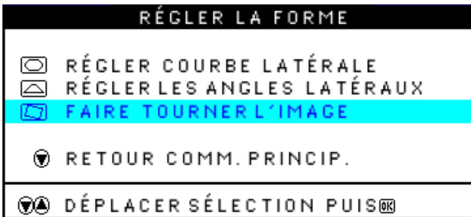
5) Appuyez sur le bouton
