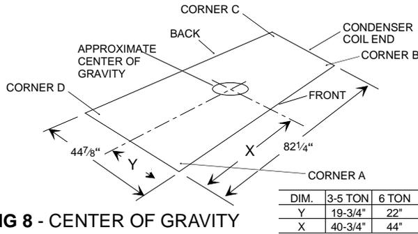
**FIG 8 - CENTER OF GRAVITY**
