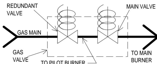
**FIG. 10 - GAS VALVE PIPING**
