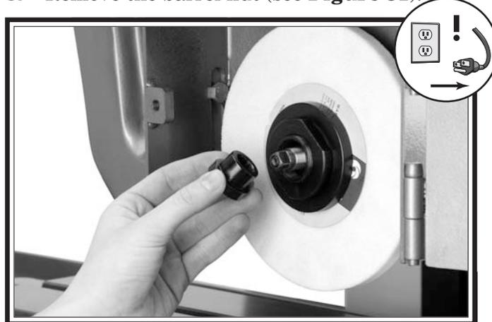
**Figure 31. Barrel nut removal.**
