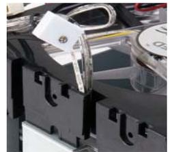
5. Fixez le montant de ventilateur et le ventilateur à l'arrière du panier HDD libre.
