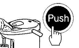
按壓的過程中，會發出操作聲音，然後開始供水。待供水停止後，再使接水容器離開出水口。
