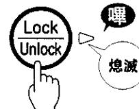
发出「囃」聲後，「解除閉鎖」顯示燈熄滅。「給湯」キーがロックされ、押しても給湯ができません。
