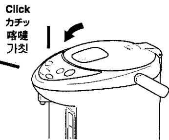
●上蓋打開時，沸騰不會停止，熱水瓶傾倒時大量開水溢出會引起燙傷。
