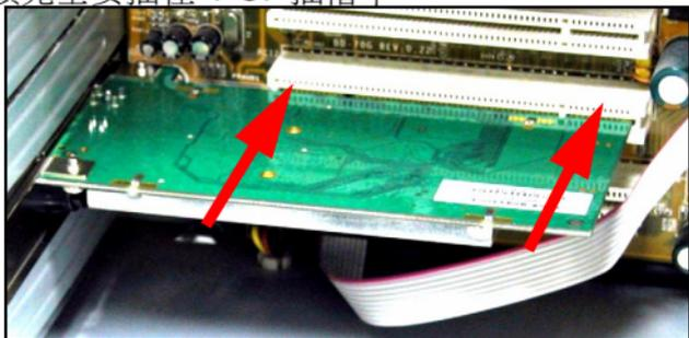
7 利用托架螺絲將 NWD-370N 固定在電腦上。
