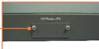
6. Задвиньте модуль TE100-SFXM в соответствующее гнездо.
