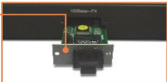
7. Закрепите модуль TE100-SFXM винтами.
