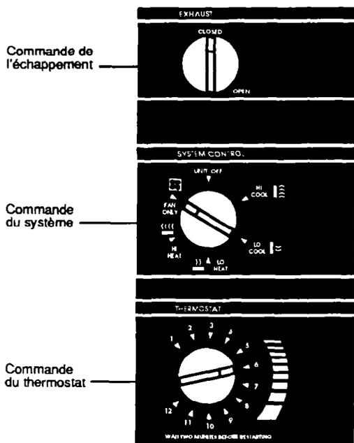
1. Mettre la commande de l'échappement sur CLOSED (fermé) pour refroidir au maximum.
