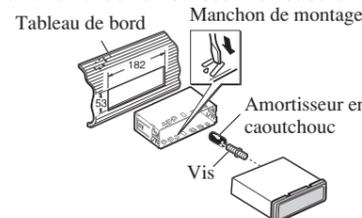
1. Insérez le manchon de montage dans le tableau de bord.
