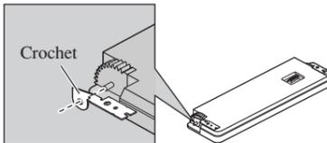
2. Remettez la face avant en place sur l'appareil.
