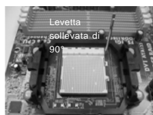
FASE 1: Sollevare la levetta socket
