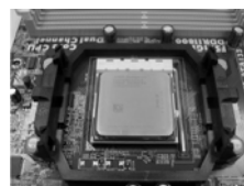
步骤 4: 下推并锁住插座拉杆
