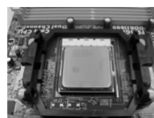
FASE 4: Abbassare e bloccare la levetta socket
