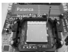
PASO 1: Levante la Palanca del Zócalo
