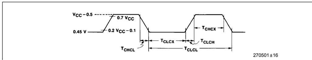
**AC TESTING INPUT, OUTPUT WAVEFORMS**
