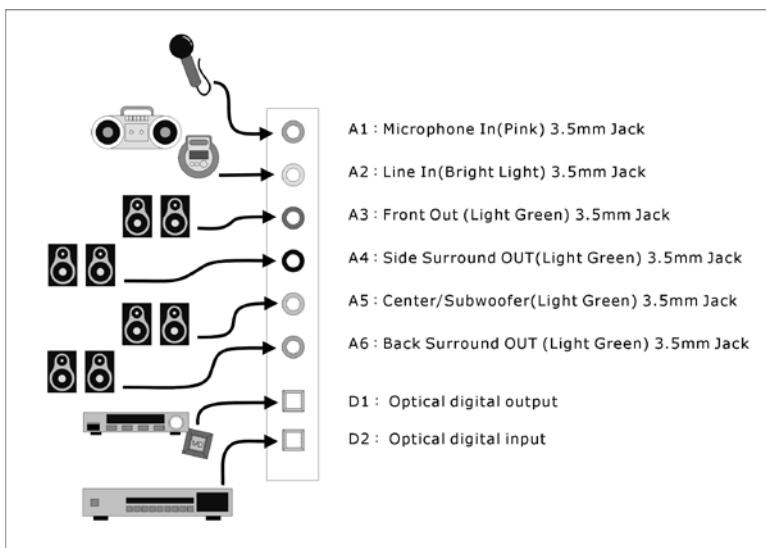
La figura a continuación muestra un ejemplo del diseño de los puertos del soporte de la tarjeta de sonido y también muestra como conectar sus dispositivos de audio a la tarjeta de sonido.
