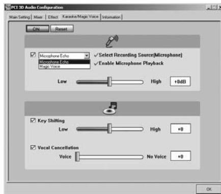
**Microphone Echo (eco del micrófono):** Efecto especial para el efecto del eco del micrófono cuando se canta.
