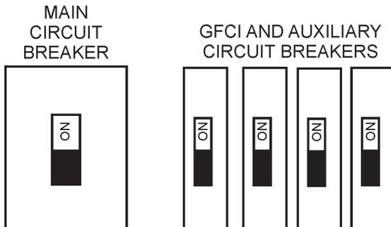
Figure 27. Main, GFCI, and Aux. Circuit Breakers (ON)
