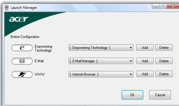
Launch Manager permite definir los 4 botones de lanzamiento fácil situados en la parte superior del teclado. Vea la sección "**Botones de lanzamiento fácil**" en la **página 27** para determinar su ubicación.
