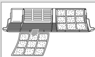
Para obtener el máximo rendimiento de su aire acondicionado, deberá limpiarlo con frecuencia para eliminar el polvo que se acumula en el filtro del aire.
