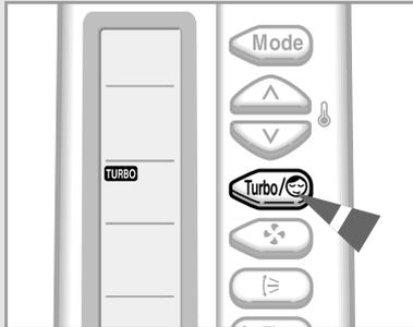
**La función de refrigeración/calefacción mediante el turbo se utiliza para enfriar o calentar la habitación lo antes posible.**
