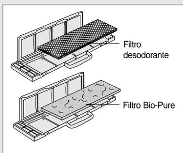
**El aire acondicionador puede ser apto con el desodorante y filtro de Bio-Pure para remover la mínima partícula de suciedad o olores. El filtro tiene una duración aproximada de tres meses dependiendo el tiempo que haya sido usado el aparato.**
