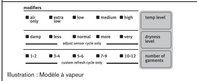
On peut ajuster différents réglages, selon que l'on a sélectionné un programme de détection, un programme minuté ou avec vapeur. Voir le "Guide de programmes" pour des informations détaillées.
