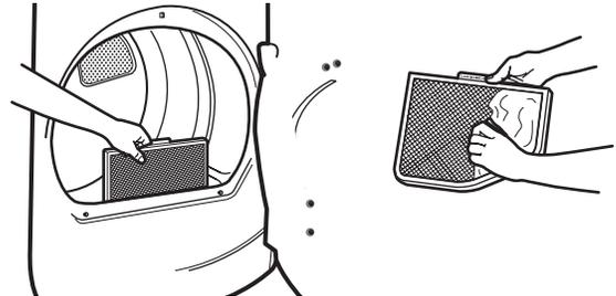
2. Remettre le filtre à charpie fermement en place en l'enfonçant.
