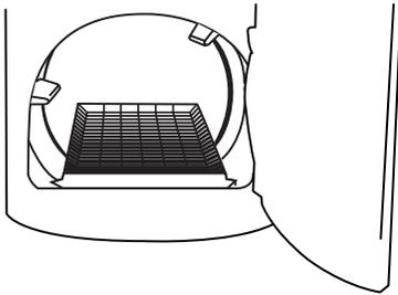
3. Placer les articles mouillés sur la grille de séchage. Laisser suffisamment d'espace entre les articles pour permettre à l'air de circuler. La grille de séchage ne bouge pas mais le tambour pivote; veiller à laisser suffisamment d'espace entre les articles et à l'intérieur du tambour de la sècheuse. Veiller à ce que les articles ne pendent pas par-dessus les bords de la grille de séchage ou entre les barreaux de la grille.
