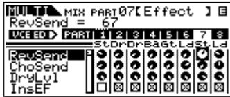
Seleccione el parámetro deseado con los botones de cursor [^][V], y seleccione la parte que desee editar con los botones de parte/elemento ([1/5/9/13]-[4/8/12/16]). A continuación utilice la rueda de datos para ajustar el nivel de envío de efecto para cada parte.
