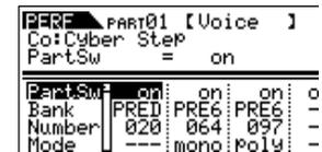
**Edición común** [SHIFT]+[PERFORM] → seleccionar performance → seleccionar edición de performance pulsando [EDIT] una o dos veces → [SHIFT]+[COMMON] → seleccionar cada pantalla con PAGE [◀|▶]
