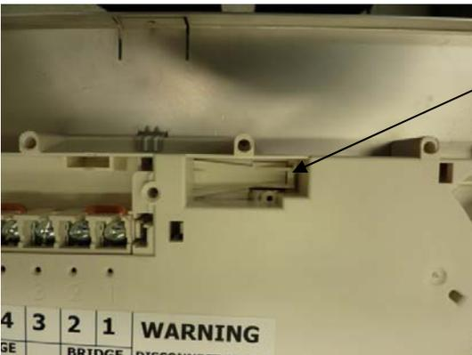
LIFT UP THE CLIP AS SHOWN TO RELEASE THE INDUCTION UNIT FROM THE MOUNTING PLATE BY SLIDING FORWARD AWAY FROM THE REMAINING RETAINING CLIPS
