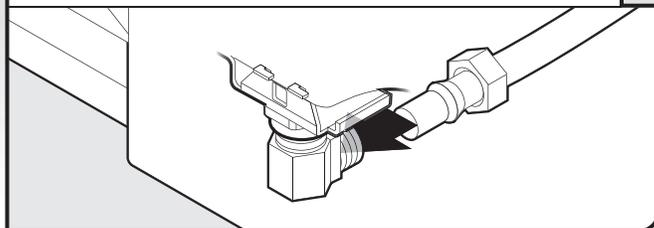
Tube de cuivre seulement : Insérer le tube dans le raccord 90°, aussi loin qu'il peut aller (travailler prudemment – il est facile de déformer/écraser le tube). Faire glisser l'écrou et la virole vers l'avant et fixer l'écrou sur le filetage du raccord coudé.
