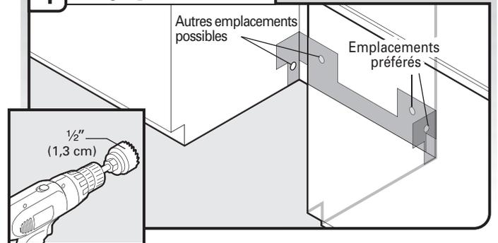
Percer un trou de  $\frac{1}{2}$ " (1,3 cm) dans le panneau latéral ou à l'arrière du placard.
