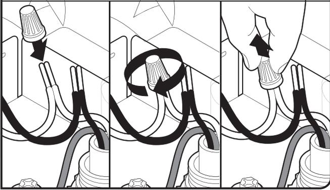
**REMARQUE :** Ne pas pré-torsader les conducteurs toronnés. Installer chaque connecteur de fils sur les conducteurs (mouvement de vissage). Tirer doucement sur les conducteurs pour vérifier qu'ils sont solidement connectés.
