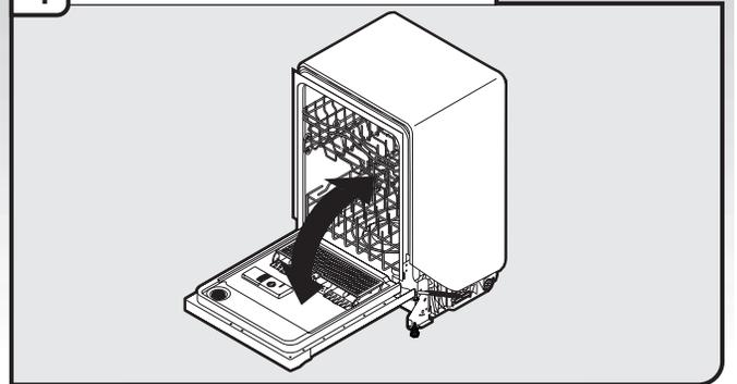
Tandis qu'une autre personne maintient le lave-vaisselle pour qu'il ne puisse basculer, effectuer plusieurs manœuvres d'ouverture et fermeture de la porte. Si la porte se ferme ou s'ouvre sous l'effet de son propre poids, il sera nécessaire d'effectuer un réglage de la tension des ressorts.
