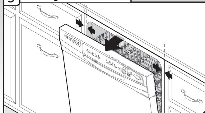
Ouvrir la porte, et vérifier que le lave-vaisselle est parfaitement centré dans la cavité d'encastrement (espacement identique à gauche et droite entre le lave-vaisselle et les placards latéraux). Si l'espacement n'est pas identique, desserrer les vis des brides de fixation et déplacer légèrement le lave-vaisselle; resserrer les vis de fixation des brides.
