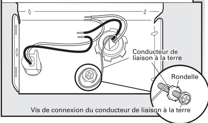
Avec le conducteur de liaison à la terre, former un crochet en U; enrouler le crochet dans le sens horaire autour de la vis de connexion du conducteur de liaison à la terre, et sous la rondelle. Bien serrer la vis de connexion.
