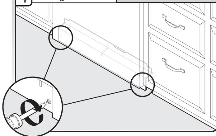
Serrer les vis de fixation du panneau de l'ouverture d'accès.
