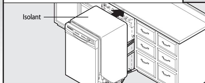
**IMPORTANT :** Si les roues ont été enlevées, protéger le sol durant le déplacement du lave-vaisselle. Insérer (lentement) complètement le lave-vaisselle dans la cavité d'encastrement. Veiller à ne pas déformer/écraser ou coincer le conduit d'arrivée d'eau, le tuyau d'évacuation, le câble d'alimentation ou le câblage direct entre le lave-vaisselle et un placard. Retirer la feuille de carton qui avait été placée sous le lave-vaisselle.
