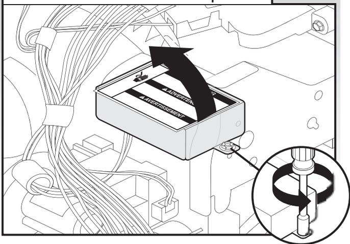
Utiliser un tourne-écrou, une clé à douille hexagonale de 1/4" ou un tournevis Phillips; démonter le couvercle du boîtier de connexion; conserver la vis et le couvercle pour réutilisation.
