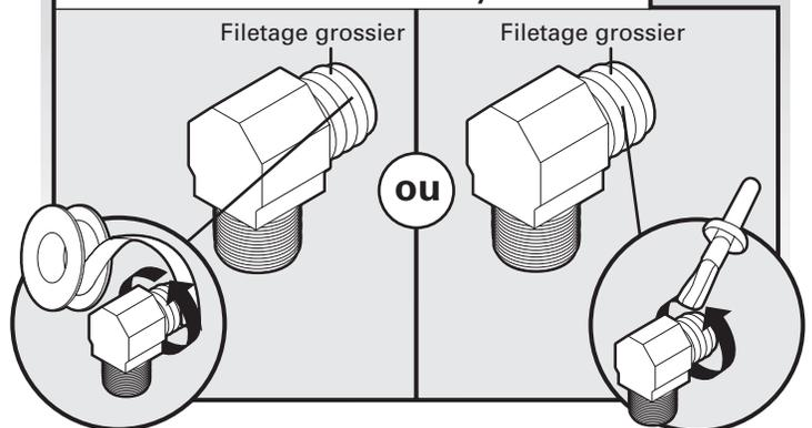
Appliquer du ruban de Teflon® ou un composé d'étanchéité des tuyauteries sur le filetage du raccord 90° (pas fourni). Lors de l'emploi de ruban de Teflon, placer deux à quatre tours de ruban sur le filetage pour assurer l'étanchéité.
