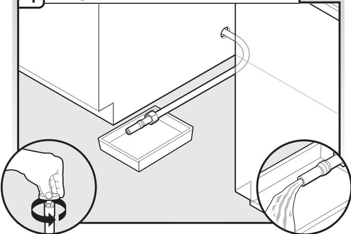
Ouvrir lentement le robinet d'arrêt à la position "ON" (marche). Laisser l'eau s'écouler dans un bac peu profond pour l'élimination de toutes les particules solides qui pourraient obstruer l'électrovanne d'admission d'eau. Refermer le robinet d'arrêt à la position "OFF" (arrêt).
