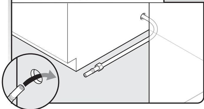
Faire passer prudemment la canalisation d'alimentation à travers le trou percé dans le placard. (Si l'on utilise un tube de cuivre, celui-ci peut s'écraser/se déformer facilement lors d'une flexion; procéder prudemment.) Il faut que la longueur de la section qui dépasse dans l'espace d'encastrement soit suffisante pour le raccordement à l'entrée du lave-vaisselle sur le côté gauche/à l'avant du lave-vaisselle.
