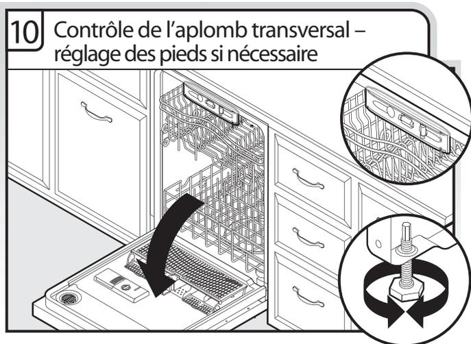
Placer un niveau contre le sommet/à l'avant de l'ouverture de la cuve. Vérifier l'aplomb transversal du lave-vaisselle. Si l'aplomb du lave-vaisselle n'est pas correct, ajuster le déploiement (abaissement/soulèvement) des pieds avant pour établir le bon aplomb du lave-vaisselle.
