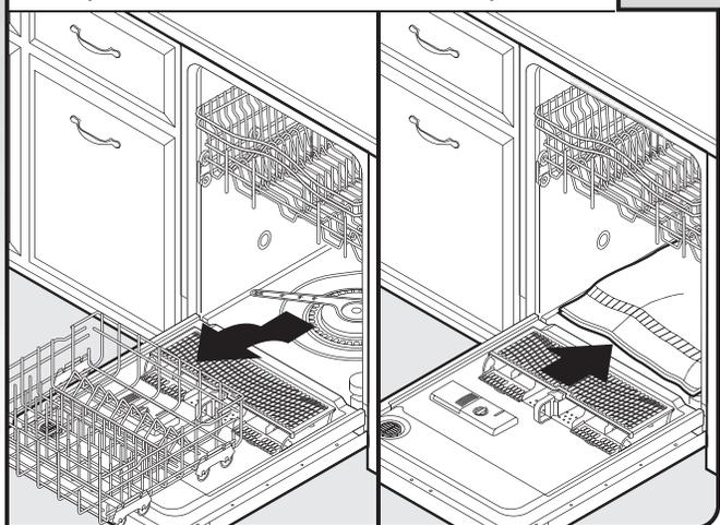
Ouvrir la porte du lave-vaisselle; retirer le panier inférieur; placer une serviette par-dessus la pompe et la rampe d'aspersion inférieure; ceci empêchera une vis qui tomberait durant l'opération d'arrimage de s'introduire dans la zone de la pompe.
