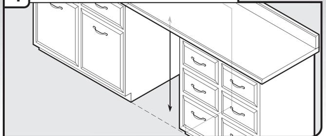
Mesurer la hauteur de la cavité d'encastrement entre les placards, entre le sol et la face inférieure du plan de travail, à l'emplacement d'installation prévu (mesurer à partir du point le plus bas de la face inférieure du plan de travail et le point le plus haut du plancher). Pour la position des roues et le nombre de rotations de vissage nécessaire, voir "Tableau de réglage - Hauteur du lave-vaisselle".
