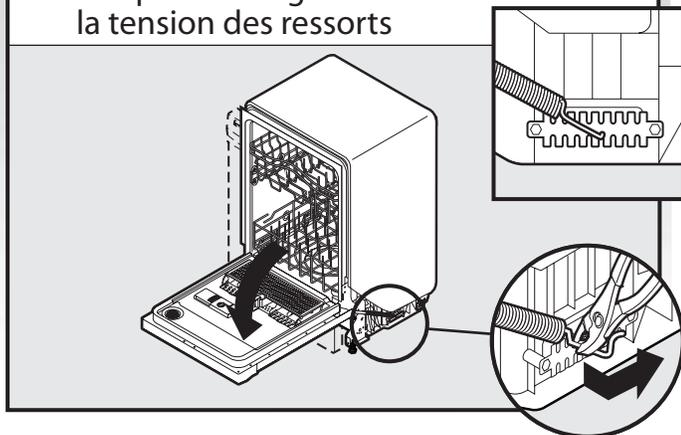
Si la porte s'ouvre sous l'effet de son propre poids, augmenter la tension des ressorts : déplacer le point d'ancrage de chaque ressort vers l'arrière du lave-vaisselle.
