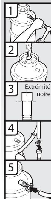
1. Arracher l'opercule arrachable du broyeur à déchets – utiliser un marteau et un tournevis.
