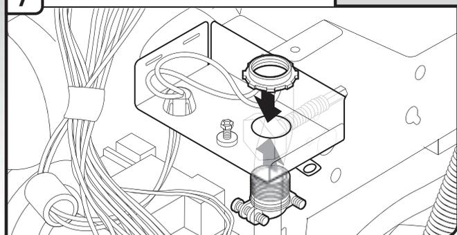
Installer un serre-câble (homologation UL ou CSA). Veiller à ce que les têtes de vis soient orientées vers la gauche après le serrage de l'écrou du connecteur de conduit. Le serre-câble pourrait être fourni avec le cordon d'alimentation.
