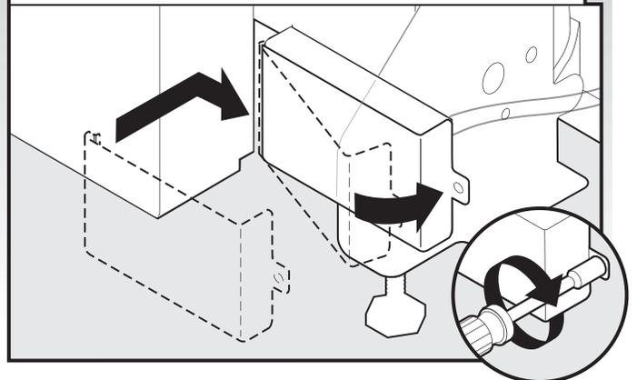
Placer les fils à l'intérieur du boîtier de connexion. Insérer les pattes du côté gauche du couvercle. Vérifier que les conducteurs sont bien engagés l'intérieur du boîtier. Fermer le couvercle - veiller à ne pas coincer des conducteurs. Utiliser un tourne-écrou de 1/4" pour réinstaller la vis de fixation du couvercle.
