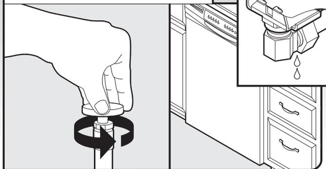
Placer un essuie-tout de papier sous le raccord 90°. Ouvrir le robinet d'arrêt de la canalisation d'arrivée d'eau. Inspecter pour rechercher d'éventuelles fuites. S'il y a une fuite, répéter les étapes précédentes.
