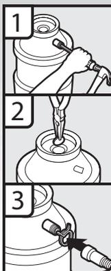
1. Arracher l'opercule arrachable du broyeur à déchets – utiliser un marteau et un tournevis.
