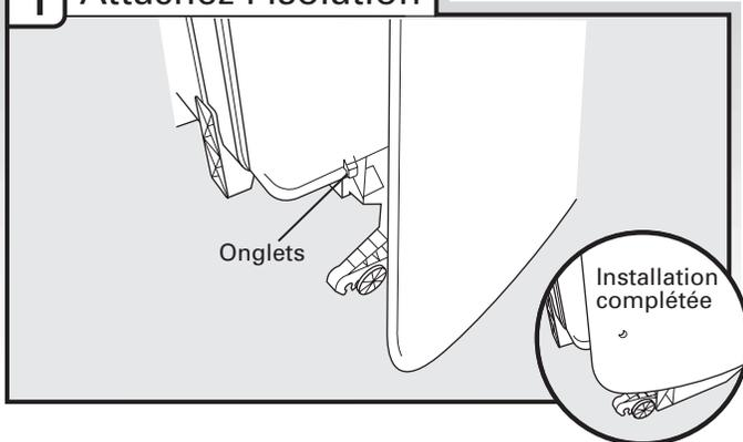
En utilisant les fentes précoupées dans l'isolation, attachez l'excédent d'isolation sur les crochets moulés sur le baquet. Soyez sûr d'attacher l'isolation vers le bas des deux côtés du baquet.
