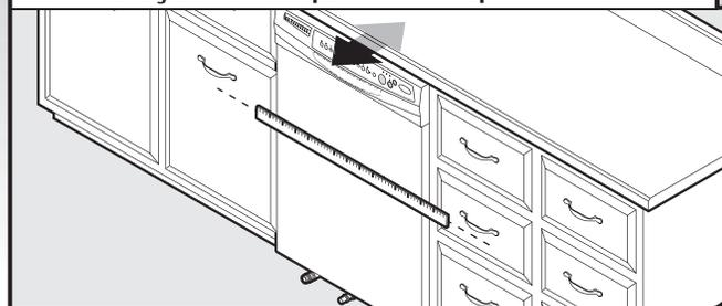
Aligner le panneau avant de la porte du lave-vaisselle avec la surface frontale des portes de placard; un ajustement peut être nécessaire.
