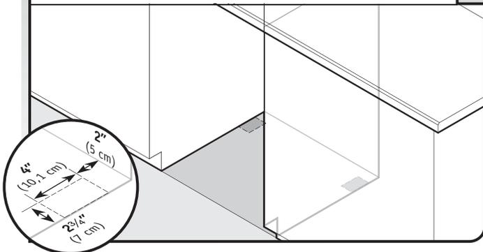
Lorsque la surface du sol de la cuisine est plus élevée que le plancher de la cavité d'encastrement (par ex. en présence d'un carrelage qui ne se prolonge pas dans la cavité d'encastrement), ajouter des cales selon le besoin aux emplacements indiqués sur l'illustration pour établir la distance de 34" (86,4 cm) entre la surface des cales et le plan de travail.
