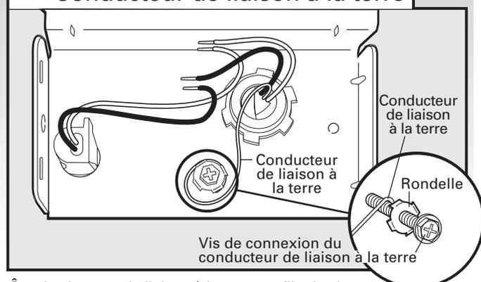
Ôter la vis verte de liaison à la terre; enfilez la vis dans la cosse du conducteur vert de liaison à la terre. Réinstallez et serrez la vis verte.
