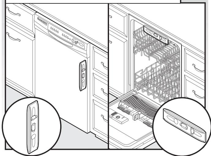
Vérifier l'aplomb vertical et l'aplomb transversal du lave-vaisselle installé dans la cavité.
