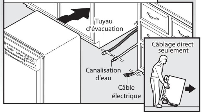
**IMPORTANT :** Vérifier le positionnement correct des éléments de raccordement (tuyau d'évacuation, conduit d'eau, câble électrique). Saisir les deux côtés du lave-vaisselle par les bords du panneau de porte. Incliner le lave-vaisselle vers l'arrière (en appui sur les roues) et rapprocher le lave-vaisselle de l'ouverture.
