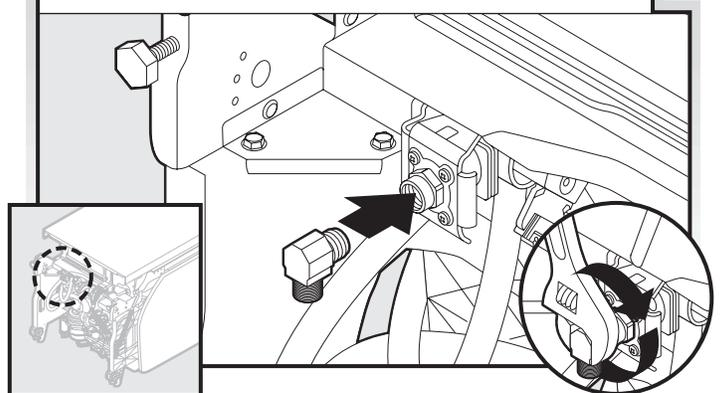
Connecter le raccord 90° sur l'électrovanne d'admission d'eau. Serrer complètement avec une clé; veiller à ce que la sortie soit orientée vers l'arrière.
