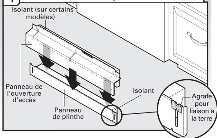
Vérifier que l'agrafe de liaison à la terre est fixée sur le panneau de plinthe. Positionner le panneau de plinthe derrière le panneau de l'ouverture d'accès. Sur certains modèles, le panneau de l'ouverture d'accès comporte un matériau isolant qui doit s'engager derrière l'isolant du panneau de plinthe.
