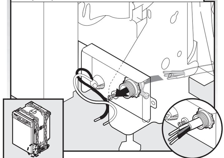
Installer le câble d'alimentation de telle manière qu'il ne soit pas en contact avec le moteur du lave-vaisselle ou la partie inférieure de la cuve du lave-vaisselle. Introduire le câble dans le boîtier de connexion à travers la bride de câble.
