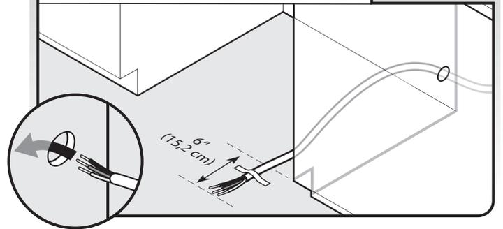
Installer un câble depuis l'alimentation électrique jusqu'à la cavité d'encastrement du lave-vaisselle, à travers le trou percé dans la paroi (la longueur du câble doit être suffisante pour qu'il puisse pénétrer dans le côté avant droit de l'ouverture d'encastrement). Fixer le câble sur le sol avec du ruban adhésif à l'emplacement indiqué, pour qu'il ne puisse bouger lors de l'insertion du lave-vaisselle dans la cavité.
