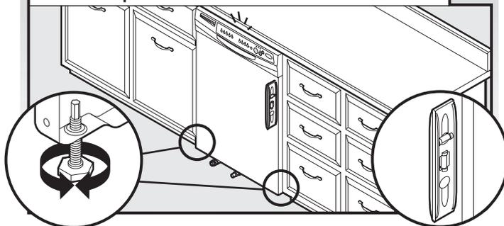
Vérifier que les pieds de réglage de l'aplomb sont fermement en contact avec le sol. Fermer et verrouiller la porte; placer un niveau en contact avec le panneau de façade. Vérifier que le lave-vaisselle est centré dans la cavité (avant/arrière). Si nécessaire, modifier le réglage des pieds pour établir l'aplomb du lave-vaisselle - effectuer ceci de chaque côté du lave-vaisselle.
