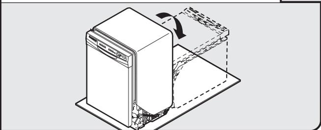
**Conseil utile :** Afin d'éviter d'endommager le revêtement de sol, laisser une feuille de carton sous le lave-vaisselle jusqu'à son installation dans la cavité d'encastrement. Ne pas utiliser le panneau de porte comme surface de travail sans d'abord l'avoir recouvert d'une serviette pour éviter de l'endommager.
