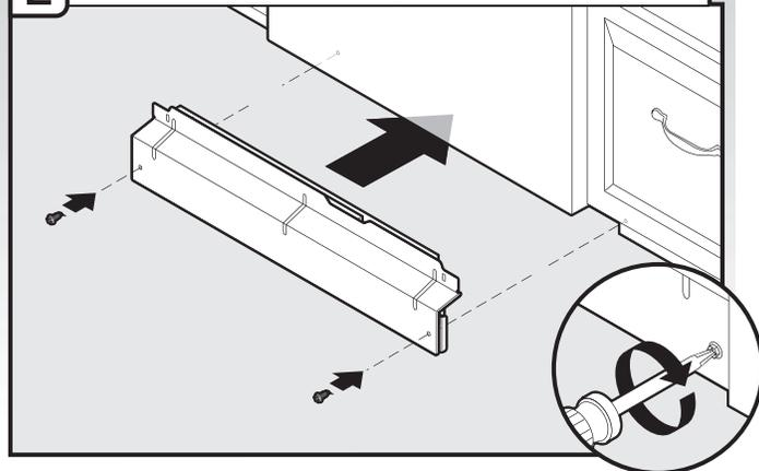
Maintenir les deux panneaux ensemble; placer les deux panneaux contre le pied du lave-vaisselle. Utiliser un tournevis Phillips ou un tournevis 1/4" pour réinstaller les vis à travers les trous du panneau de l'ouverture d'accès et du panneau de plinthe.
