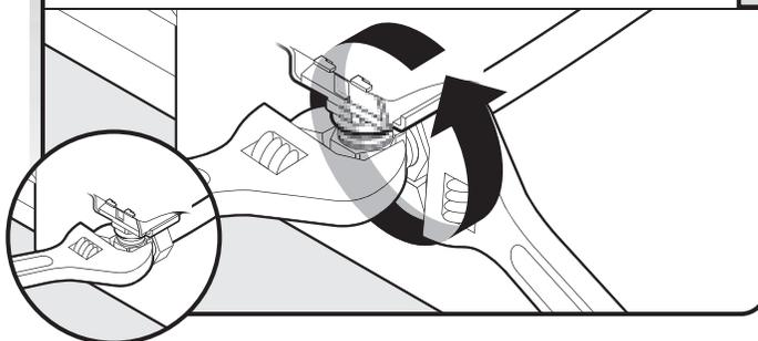
Utiliser une clé à molette pour immobiliser le raccord 90°; serrer l'écrou avec une seconde clé à molette.
