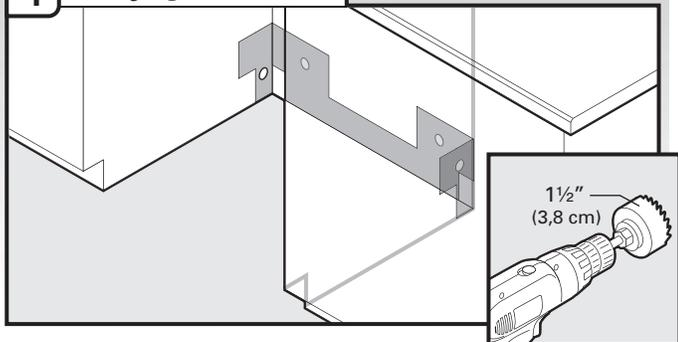
Si nécessaire, percer un trou de diamètre 1 1/2" (3,8 cm) dans la paroi du placard ou de l'ouverture la plus proche de l'évier.
