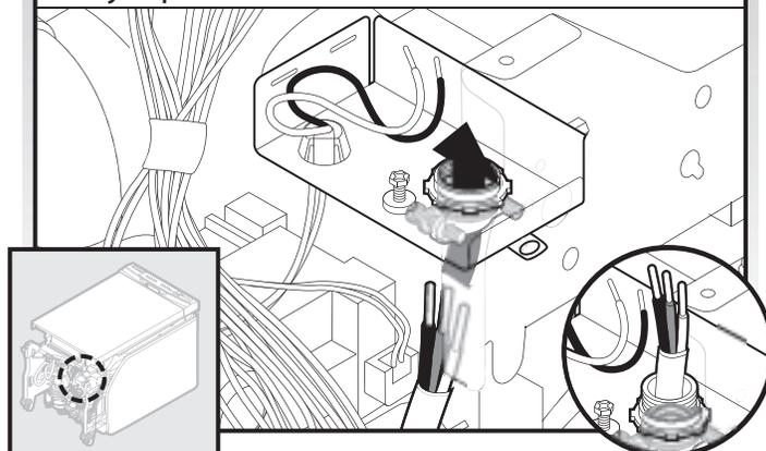
Installer le cordon d'alimentation de telle manière qu'il ne soit pas en contact avec le moteur du lave-vaisselle, jusqu'à la partie inférieure de la cuve du lave-vaisselle. Introduire le cordon dans le boîtier de connexion à travers le serre-câble.
