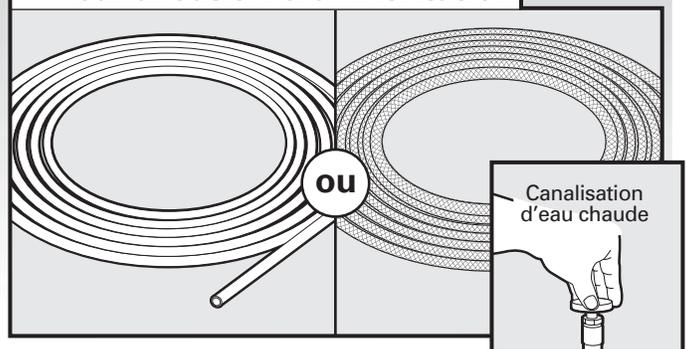
Mesurer la longueur totale nécessaire de tube de cuivre ou de tube flexible (avec tressage de renforcement). Effectuer le raccordement sur la canalisation d'eau chaude avec un raccord ou autre dispositif conforme aux prescriptions des codes et règlements en vigueur. La canalisation d'arrivée d'eau devrait comporter un robinet d'arrêt manuel.
