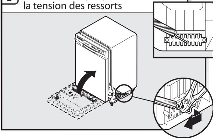
Si la porte se ferme trop rapidement, réduire la tension des ressorts : déplacer le point d'ancrage de l'extrémité du ressort vers l'avant du lave-vaisselle.
