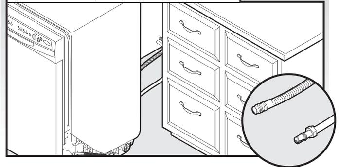
Vérifier que le conduit d'arrivée d'eau est placé sur le côté gauche de la cavité et que le tuyau d'évacuation est placé près du centre de la cavité.
