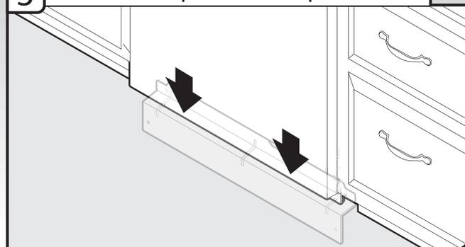
Vérifier que la rive inférieure du panneau de plinthe est en contact avec le sol; ajuster selon le besoin.
