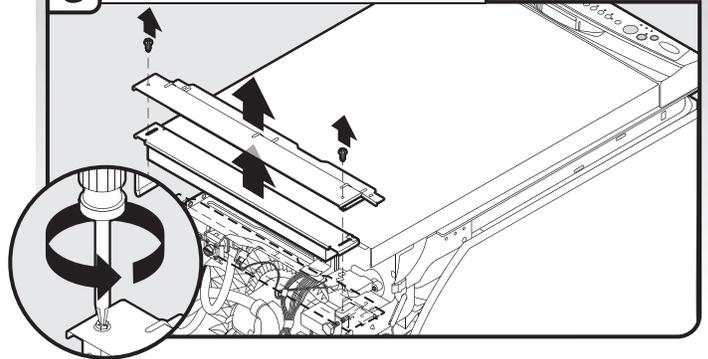
Utiliser une clé à douille hexagonale ou tourne-écrou de 1/4" ou un tournevis Phillips; ôter les deux vis fixant le panneau de l'ouverture d'accès et le panneau inférieur sur le lave-vaisselle.
