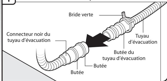
Placer une serviette sous le tuyau d'évacuation pour récupérer toute quantité d'eau qui peut s'écouler du tuyau. Placer la bride de tuyau verte (petite bride) sur l'extrémité de petit diamètre du tuyau d'évacuation. Enfoncer le nouveau tuyau d'évacuation dans le connecteur noir jusqu'au point de butée.
