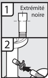
1. Connecter l'extrémité noire du tuyau d'évacuation sur le raccord T du circuit de plomberie; couper si nécessaire.
