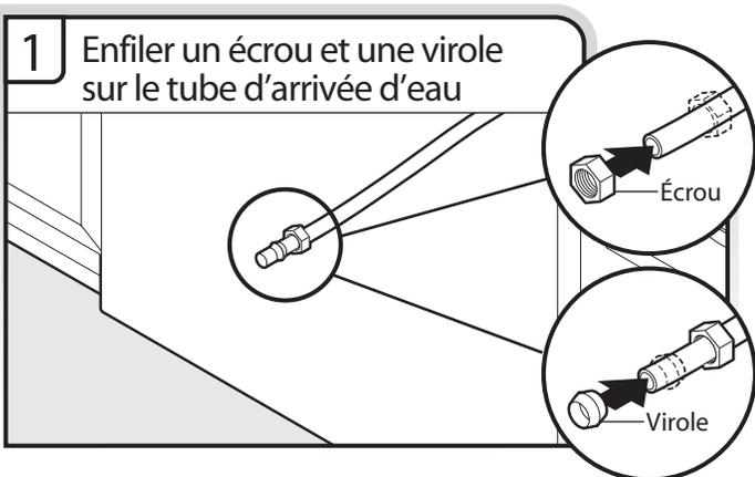
Tube de cuivre seulement : Placer l'écrou et la virole à environ 1" (2,5 cm) de l'extrémité du tube en cuivre.
