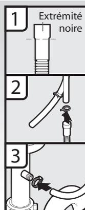
1. Connecter l'extrémité noire du tuyau d'évacuation sur le brise-vidé; couper si nécessaire.
