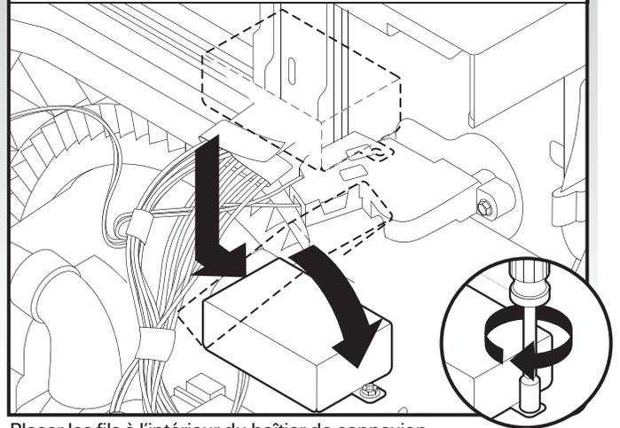
Placer les fils à l'intérieur du boîtier de connexion. Insérer les pattes du côté gauche du couvercle. Vérifier que les conducteurs sont bien engagés à l'intérieur du boîtier. Fermer le couvercle - veiller à ne pas coincer des conducteurs. Utiliser un tourne-écrou de 1/4" pour réinstaller la vis de fixation du couvercle.
