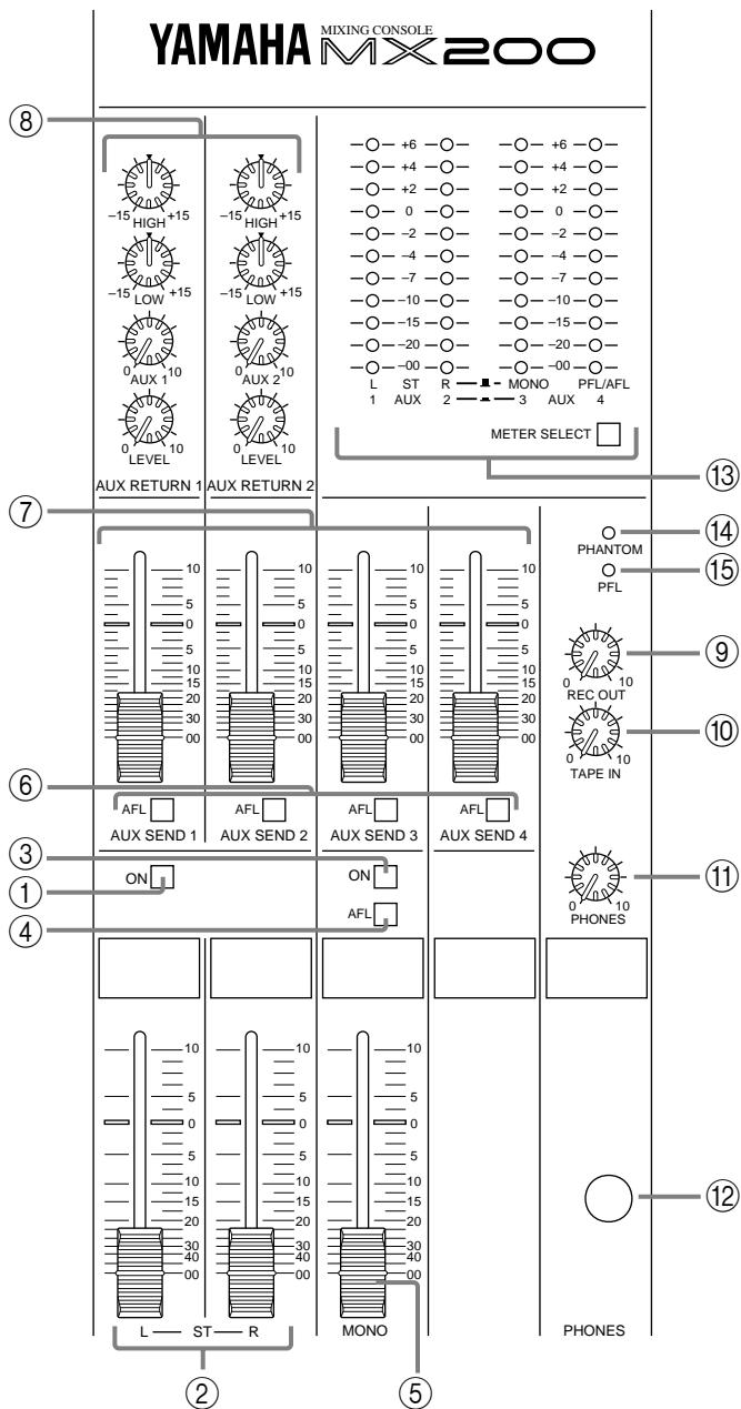
Los medidores estereofónicos (ST) le permiten controlar las salidas izquierda (L) y derecha (R).
