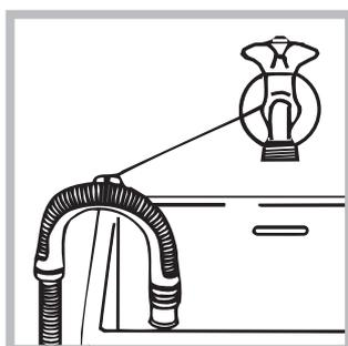
Autrement, accrocher le tuyau de vidange à un évier ou à une baignoire, dans ce cas, fixer le support plastique fourni avec l'appareil au robinet (voir figure). L'extrémité libre du tuyau de vidange ne doit pas être plongée dans l'eau.
