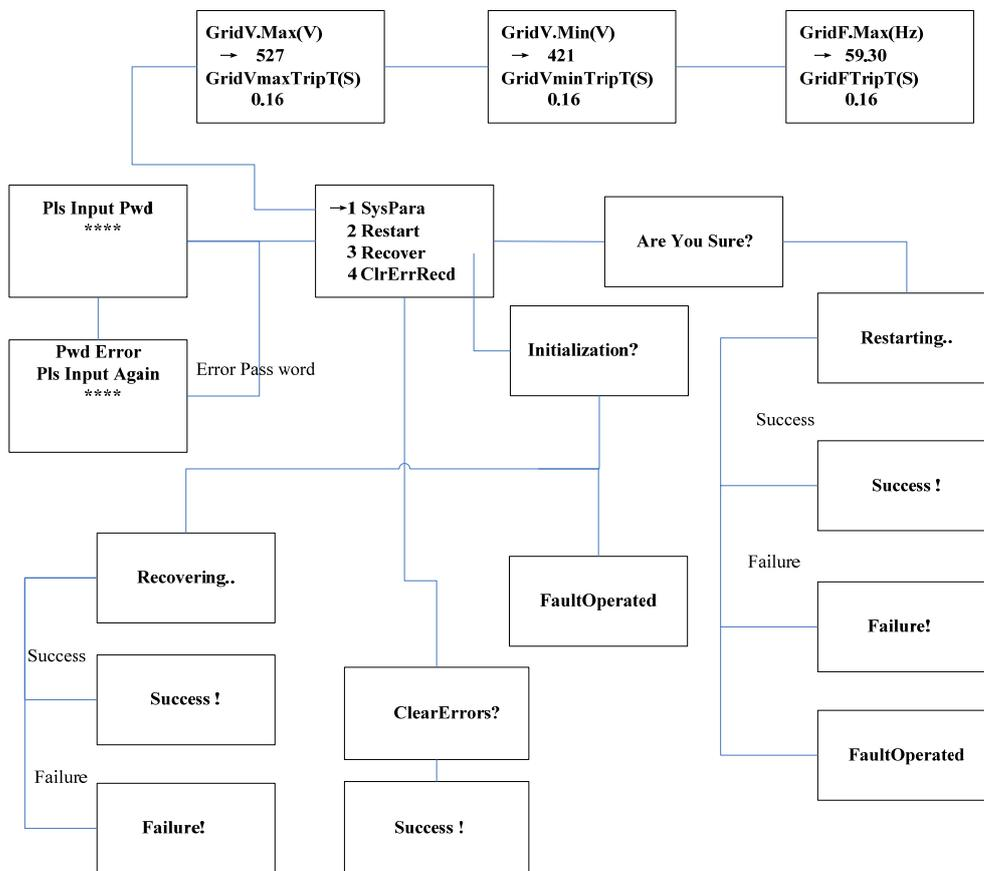
Figure 6-11 System parameter setup
