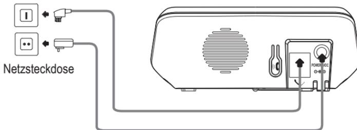
**⚠ Achtung:** Verwenden Sie für die Basisstation nur das mitgelieferte Steckernetzgerät! Sie dürfen den Zugang zum Netzteil nicht durch Möbel oder andere Gegenstände versperren.
