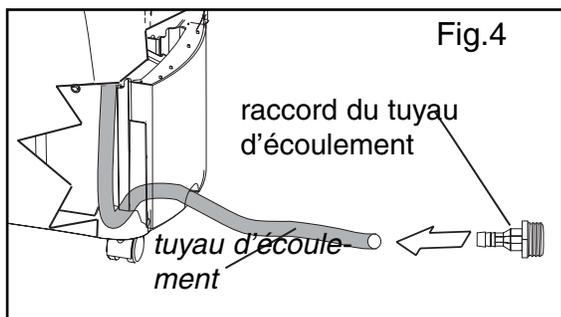
**Remarque:** Il faut se rappeler de renverser les procédé ci-dessus lors du déplacement de l'appareil à une autre location où l'option d'écoulement continu (drainage direct) est impossible. Défaut de suivre ces procédés occasionnera une inondation.
