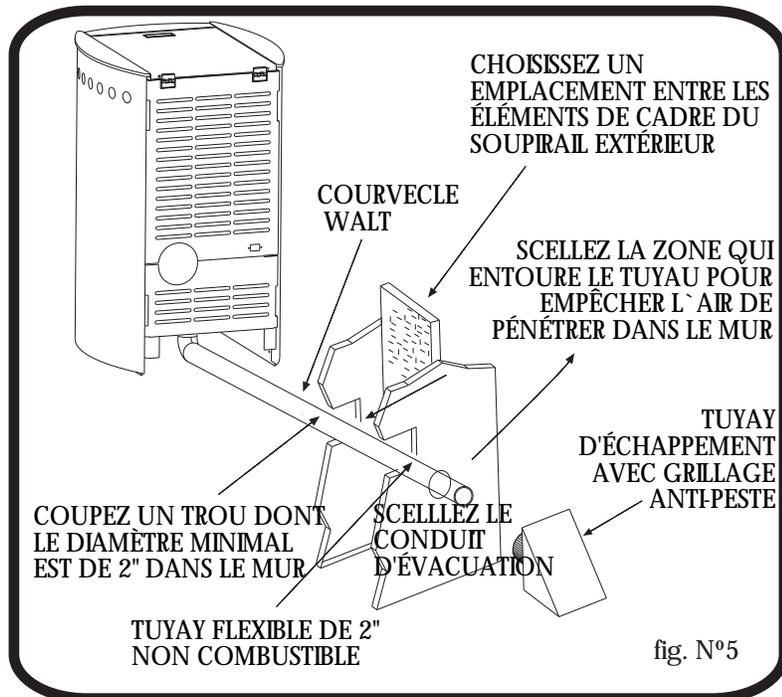
Uniquement dans le cas d'une installation dans un mobile home : Vous pouvez utiliser un tuyau de 2" de diamètre interne pour le premier mètre et demi d'alimentation en air de combustion. Au-delà de cette distance, utilisez deux tuyaux de 1,5 à 3 mètres de long et de 3/4" de diamètre interne. L'alimentation en air de combustion ne peut excéder 10 pieds.
