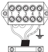
Bij een afwijkend voltage moet de aansluiting worden uitgevoerd zoals weergegeven in het aansluitschema op de onderste beschermkap.
