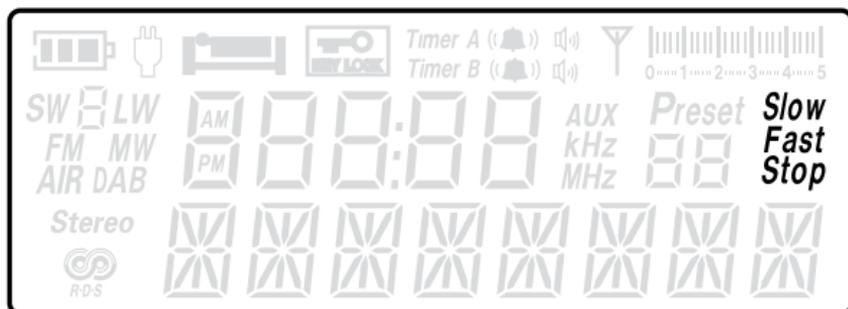
Para el modo "SLOW" (LENTO), gire la perilla de sintonización para aumentar o disminuir la frecuencia para FM en 10 kHz, OM en 1 kHz, OC en 1 kHz;
