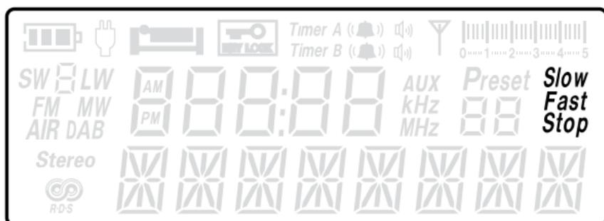
Pour le mode « SLOW » (lent), tournez la molette de syntonisation pour augmenter ou diminuer la fréquence pour la FM à 10 kHz, MW à 1 kHz, SW à 1 kHz ;
