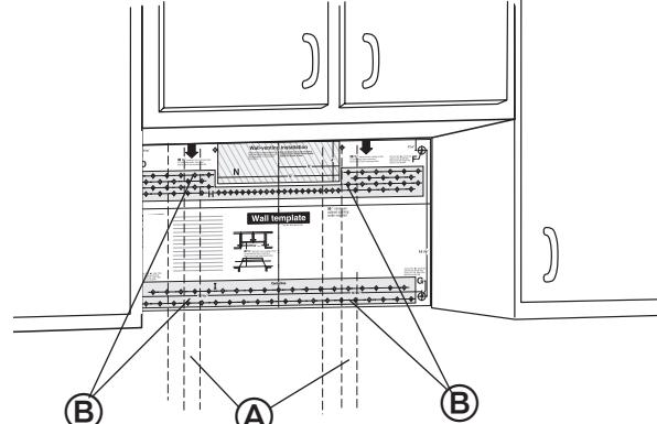
Verifique que los puntos "D" y "E", o "F" y "G" de la plantilla de pared estén sobre un montante de pared ④: si los puntos están sobre un montante de pared, haga orificios de 3/16". Si los puntos están sobre un muro interior sin mortero, haga orificios de 3/4".
