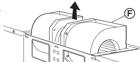
Levante la unidad del soplador (**F**) y sáquela del gabinete de la campana del microondas.
