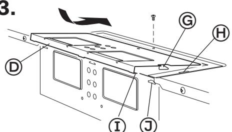
Vuelva a sujetar la unidad del soplador a la parte posterior del gabinete de la campana del microondas con los dos tornillos que quitó en el Paso 9. Apriete los tornillos firmemente.
