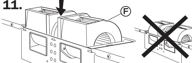
Gire la unidad del soplador (**F**) de manera que los orificios de escape **miren hacia la parte superior** del gabinete y los lados planos de la unidad del soplador miren hacia la parte posterior del gabinete de la campana del microondas. Baje la unidad del soplador y colóquela nuevamente en el gabinete.
