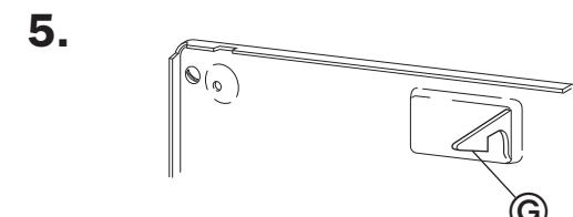
Gire la parte delantera del gabinete del horno hacia abajo. Pase el cable de alimentación por el orificio para el cable de alimentación en la base del gabinete superior.
