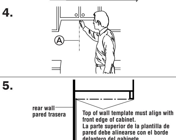
Con una cinta de medir, localice y marque con claridad la línea central vertical **A** de la abertura del gabinete en la pared directamente debajo del gabinete superior.
