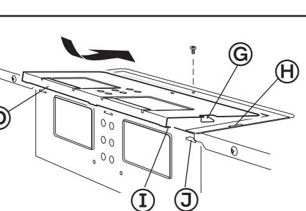
Vuelva a sujetar la unidad del soplador a la parte posterior del gabinete de la campana del horno de microondas con los dos tornillos que quitó en el Paso 3.
