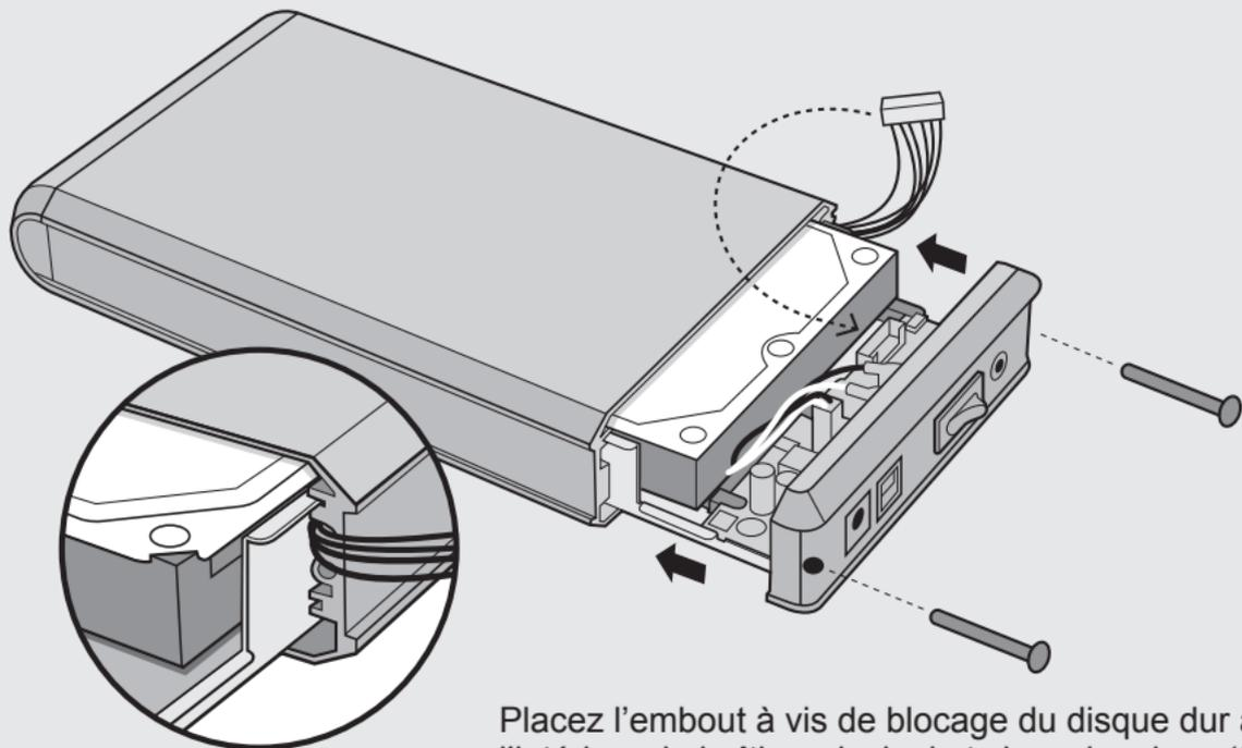
Placez l'embout à vis de blocage du disque dur à l'intérieur du boîtier principal et visser les deux (2) vis.
