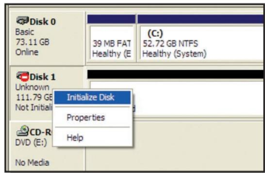
Cliquer avec le bouton droit sur le Disque 1 de cet exemple, puis sélectionner « Initialize » afin d'initialiser le disque.
