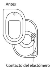
**Nota:** Asegúrese de que el contacto de elastómero pequeño situado dentro de la unidad como se muestra no se caiga durante el proceso de reemplazo.
