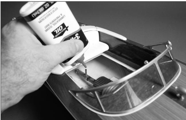
Bitte lösen Sie nach jedem Fahrtag die Welle, reinigen diese von Verschmutzung und ölen Sie die Welle.
