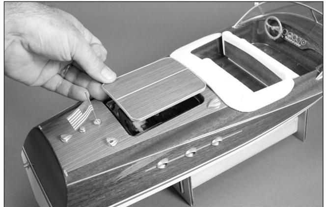
2. Setzen Sie den vollständig geladenen 8,4 Volt Akku Pack in den Rumpf ein. (Folgen Sie zum Laden des Akkus den Anweisungen des Schnellladers)
