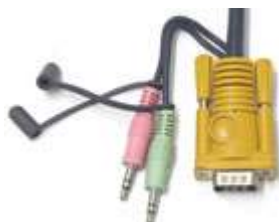
Cable Display End
