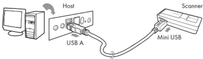
1. Flip open the mini USB port on the scanner.
