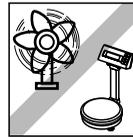
Vermeiden Sie Zugluft (z.B. von Ventilatoren oder Klimaanlage).
