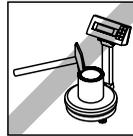
Verschliessen Sie Farbdosen, die sich noch auf der Waagschale befinden niemals mit einem Hammer.
