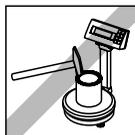
Ne fermez jamais à l'aide d'un marteau les pots de peinture se trouvant encore sur le plateau de la balance.
