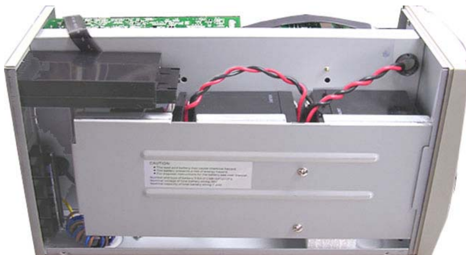
Fig. 3.2.1.2 1K Internal batteries
